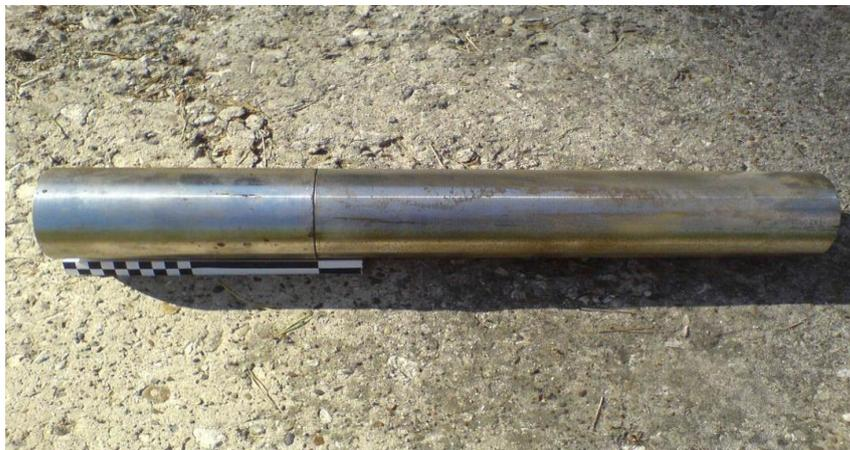
Сущность метода заключается в оценке реакции (взрыв, горение, отказ) взрывчатых материалов, помещенных в испытательную сборку (закрытую стальную трубу), на воздействие поражающего элемента, летящего с заданной скоростью. Форма, масса и скорость поражающего элемента могут варьироваться.
