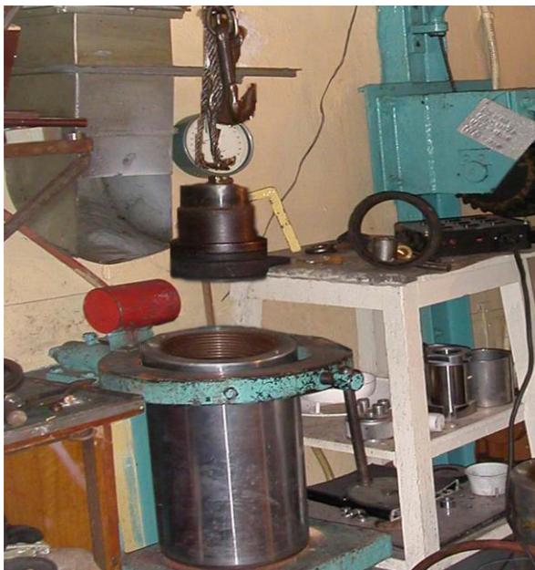
Данный метод разработан в соответствии с требованиями ОСТ В 84-1502-77 «Вещества взрывчатые бризантные. Метод определения теплоты взрыва».
