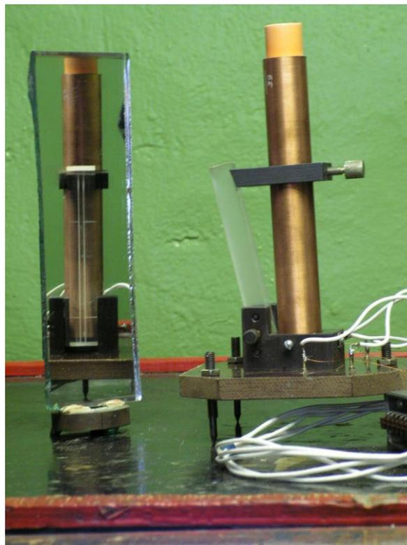
Метод основан на регистрации процесса расширения медной цилиндрической оболочки (трубки) под действием продуктов детонации исследуемого ВМ. Удар стенки трубки о пластину-отсечку регистрируется фотохронографическим способом. Одновременно измеряется скорость детонации исследуемого образца ВМ.
