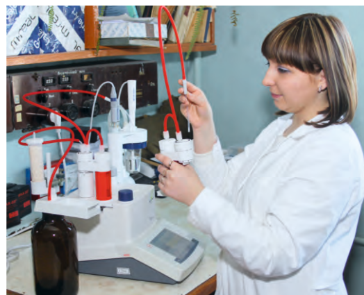
Проведение анализа испытуемых веществ с помощью автоматического титратора
